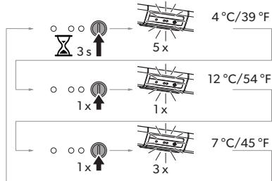
> Réglage du mode Silencieux (veille) (uniquement pour les modèles C40S1, C40S2, C40P1, C40P2, C40G1, C40G2, C60S1, C60S2, C60G1 et C60G2 avec refroidissement par compresseur) : fig. **4** à la page 18
