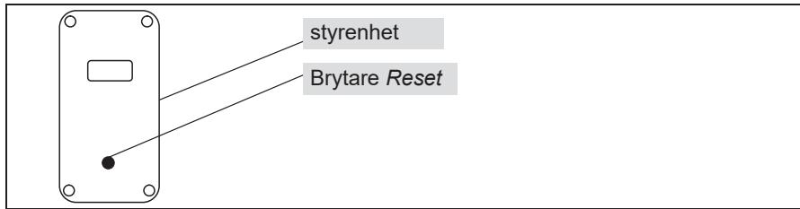
Bild 12: Styrenhet kylanläggning för stillastående användning med Reset-knapp
