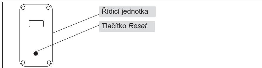
Obrázek 12: Řídící jednotka nezávislého chlazení s tlačítkem Reset
