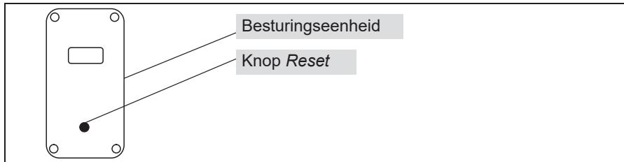
Afbeelding 12: Besturingseenheid standkoeling met knop Reset
