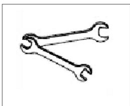
Использовать два ключа, чтобы равномерно ослабить или затянуть соединения трубопровода хладагента
