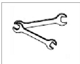
Utilizar dos llaves para soltar uniformemente las uniones de las conducciones de refrigerante o para atornillarlas firmemente.
