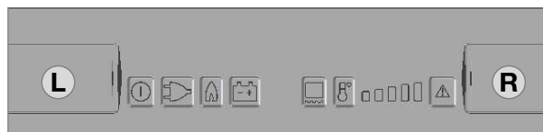
Kontrolpanelet med batterifaget (L, R)
