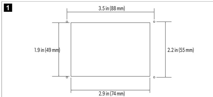
2. Marque las dimensiones de la abertura y la ubicación de los orificios de los tornillos en la pared de la cabina.
