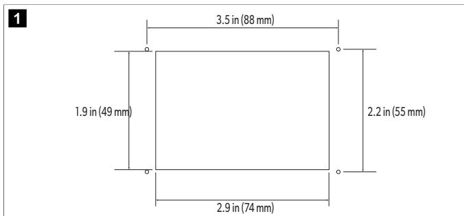
2. Marquez les dimensions de l'ouverture et les emplacements des trous de vis sur la paroi de la cabine.
