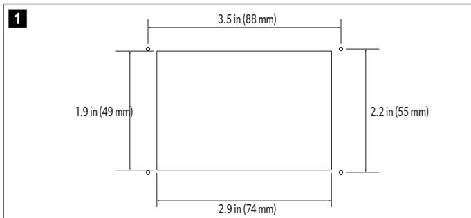
2. Markieren Sie die Abmessungen der Öffnung und die Positionen der Schraubenlöcher an der Kabinenwand.
