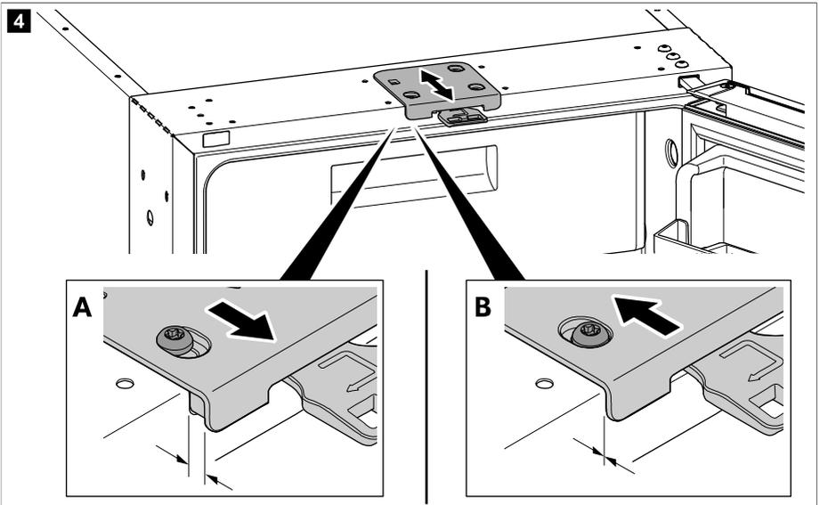
**i** **提示** 如果冰箱门门锁位于 **B** 位置，请确保关闭冰箱门时门锁锁定到位（请参阅“关闭和固定冰箱门页 97”一章）。
