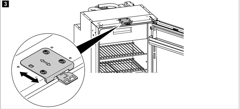
**i** **提示** 检查冰箱上是否安装了可调式门门锁。必要时订购一个可调式门门锁 (dometic.com)，并将原有的固定式门门锁替换成可调式门门锁。
