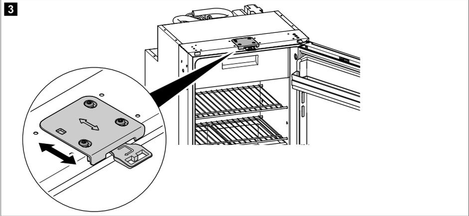
**i** 참고 조절식 도어 걸쇠가 설치되어 있는지 확인하십시오. 필요하면 조절식 도어 걸쇠(dometic.com)를 주문하여 고정식 도어 걸쇠를 조절식 도어 걸쇠로 교체합니다.
