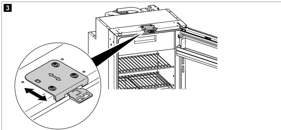
**i** **提示** 检查冰箱上是否安装了可调式门门锁。必要时订购一个可调式门门锁 (dometic.com), 并将原有的固定式门门锁替换成可调式门门锁。
