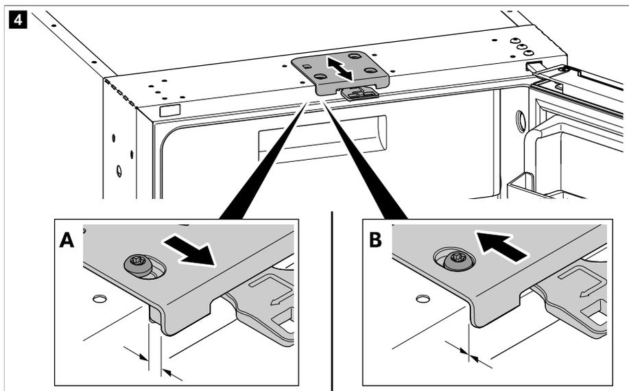
**i** **提示** 如果冰箱门门锁位于 **B** 位置, 请确保关闭冰箱门时门锁锁定到位 (请参阅“关闭和固定冰箱门页 92”一章)。
